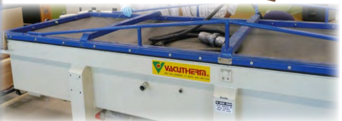
Séchoir sous-vide et sous pression de Vacutherm : diminue le temps et minimise les défauts de séchage
